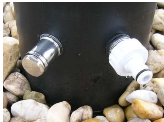
výpustný otvor so zátkou (vľavo) vstupná armatúra s hadicovou rýchlospojku (vpravo)
