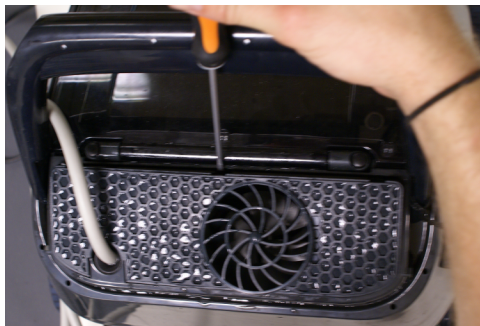
7.1 Pomocí plochého šroubováku vyjměte ochrannou mřížku.
