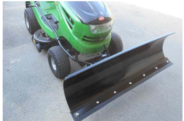
6. Nasadte radlici, zasuňte čep a zajistěte podložkou a závlačkou.
