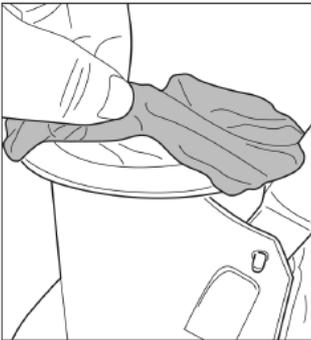
Roztáhněte filtrační vak na horní otvor základní jednotky bazénového vysavače.
