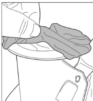
Rozložte filtračné vrečko na horný otvor základnej jednotky bazénového vysávača.
