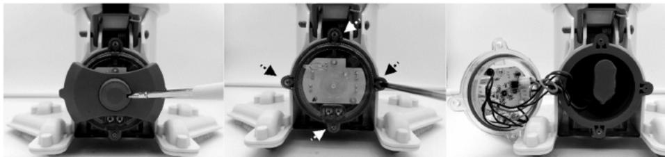
2. Chcete-li odpojit připojovací vodič baterie, zatlačením na sponu konektoru jej vytáhněte. **Poznámka:** Konektor okamžitě obalte izolační páskou, aby nedošlo ke zkratu způsobenému kontaktem obou svorek vodiče.
