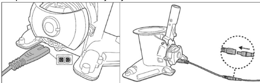
3. Pripojte nabíjací adaptér k zdroju napájania. Kontrolka na nabíjacom adaptéri sa rozsvieti na červeno, ak sa vysávač nabíja, kontrolka sa rozsvieti na zeleno, keď je vysávač úplne nabitý. Na dosiahnutie najlepšej životnosti vysávača nabíjajte 5 až 6 hodín.
