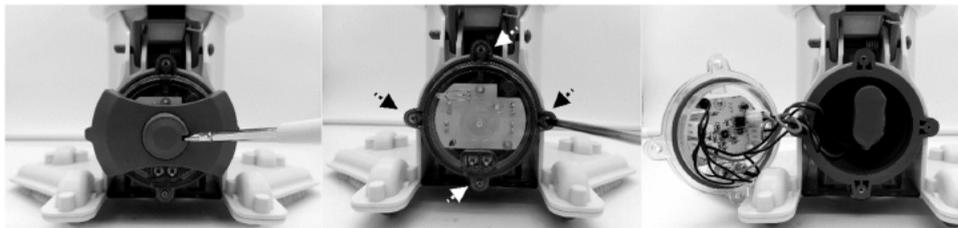
2. Ak chcete odpojiť pripojovací vodič batérie, stlačte svorku konektora a vytiahnite ho. Poznámka: Konektor ihneď omotajte izolačnou páskou, aby ste zabránili skratu spôsobenému kontaktom medzi dvoma svorkami vodiča.
