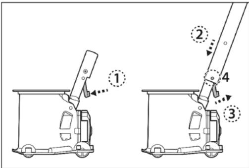
Zarovnejte a zasuňte teleskopickou tyč na sloupek, jak je znázorněno níže, dokud nejsou otvory na boční straně teleskopické tyče zajištěny ke kolíkům sloupku.
