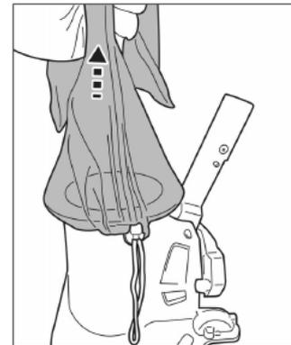
Před použitím bazénového vysavače zatáhněte za vak, abyste se ujistili, že je dobře zajištěn.
