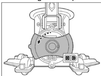
2. Zarovnajte a pripojte nabíjaciu redukciu k nabíjacímu portu. **VAROVANIE!** Dávajte pozor, aby ste nabíjaciu redukciu neprevrátili, a pred nabíjaním sa uistite, že nabíjacia redukcia a nabíjací port sú čisté a suché. TIP: Na vysušenie portov a kolíkov použite vatový tampón. Zapojte kábel z nabíjacieho adaptéra do otvoru v nabíjacej redukcii.
