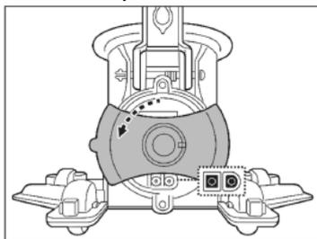
2. Zarovnejte a připojte nabíjecí redukci k nabíjecímu portu. **VAROVÁNÍ!** Dbejte na to, abyste nabíjecí redukci neobrátili a před nabíjením zajistěte, aby byly nabíjecí redukce i nabíjecí port čisté a suché. TIP: Použijte vatový tampon k vysušení portů a kolíků. Připojte kabel od nabíjecího adaptéru do otvoru v nabíjecí redukci.
