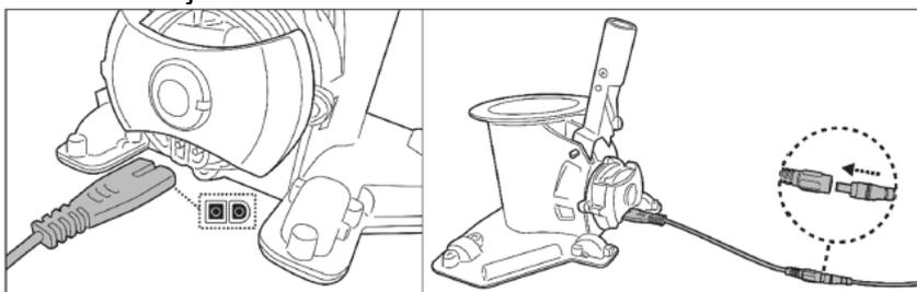
3. Připojte nabíjecí adaptér ke zdroji napájení. Kontrolka na nabíjecím adaptéru zčervená, pokud se vysavač nabíjí, až bude plně nabitý, kontrolka zezelená. Abyste dosáhli nejlepší výdrže vysavače, nabíjejte jej po dobu 5-6 hodin.
