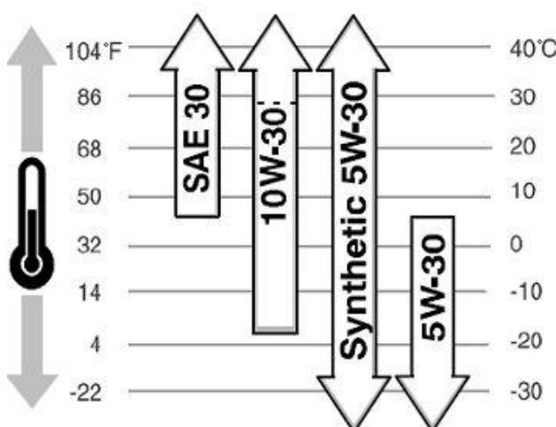
**Poznámka:** Za teplot pod 4 °C způsobí použití oleje SAE 30 obtížný start. Za teplot vyšších než 27 °C se může u olejů třídy SAE 10W-30 zvýšit jejich spotřeba. Kontrolujte hladinu oleje častěji.
