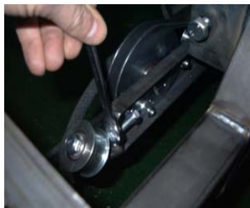
Pootáčením šroubu docílíte optimálního napnutí pohonného řemenu
