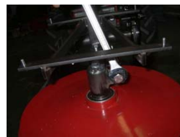
Šroubem O4 nastavte optimální napnutí pohonného řemenu.
