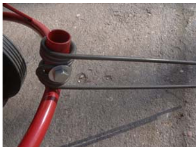
Nasadte vidlici a pomocí klíčů dotáhněte zajišťovací šroub tak, aby se vidlice mohla na držáku volně pohybovat.
