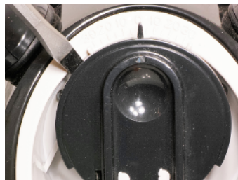
10.1 Demontujte sestavu klapky pro vyčištění nečistot nebo vlasů v oběžném kole .
