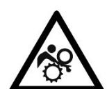
Ryzyko wciągnięcia do mechanizmu podającego.
