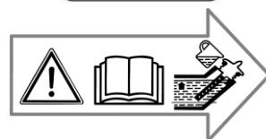
Attenzione, controllare il livello dell'olio prima di ogni avviamento!
