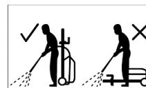
Myčka se musí používat na bezpečném a stabilním podkladu ve stojící, vzpřímené pozici.
