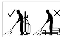
Der Hochdruckreiniger muss auf einer sicheren und stabilen Unterlage in aufrechter Position benutzt werden.
