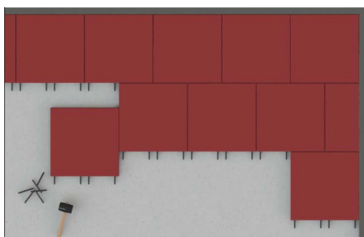
Obr. K1: Pokládka čtvercových dlaždic „na cihličku“
