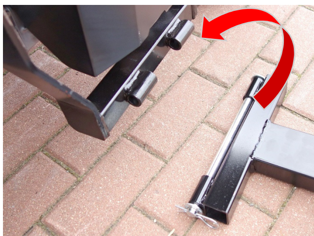
15. Nasadte radlicu, zasunúťe čap a zaistite závlačkou. Vyberte vhodný profil aretácie páky radlice (C / D) ten priložte ku konzole rámu a zaistite skrutkami.
