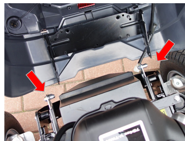
14. Namontujte kapotu späť, zaistite ju pomocou závlačky a zapojte napájací kábel svetiel.
