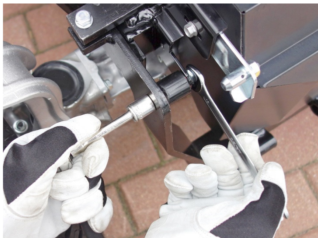
11. Prednú hornú časť rámu zoskrutkujte s vrchným otvorom v šasi, ktorý pôvodne niesol nárazník traktora.
