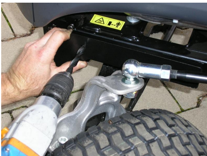
6. Přiložte druhý bok rámu k šasi traktoru na levé straně tak, aby lícoval vpředu se šasím. Označte otvor v rámu, vyvrtejte a vložte třetí šroub.
