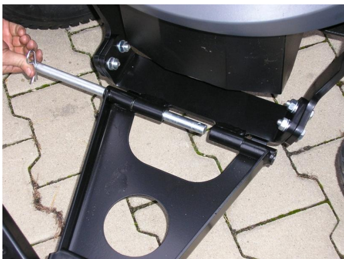
10. Po dotažení rámu přiložte smontovanou sněhovou radlici. Zasuňte čep a zajistěte závlačkou.
