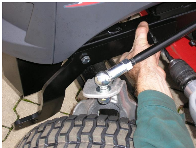
7. Označte čtvrtý otvor, vyvrtejte a vložte šroub. Šrouby lehce dotáhněte.
