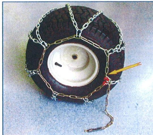
5. Napnutí ukončíme pomocí napínacího přebytku vnějšího bočního řetězu, který postupně omotáme a utáhneme kolem již upnutého bočního řetězu. Napnutý gumový napínač potom zaklešneme do vhodného článku bočního řetězu.
