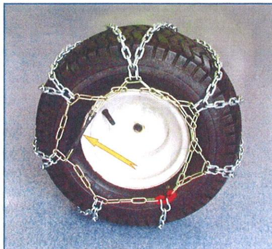
Vozidlem projedeme dráhu cca 20 m vpřed i vzad, zkontrolujeme napnutí a podle potřeby dopneme. Obvykle postačuje dopnutí pomocí přebytku bočního řetězu.
