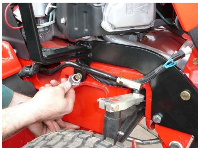
7. Do třetího otvoru našroubujte samořezný šroub. Opakujte na druhé straně.
