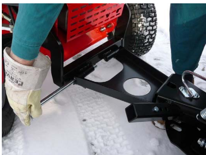
9. Po dotažení rámu nasad'te smontovanou sněhovou radlici. Zajistěte závlačkou.
