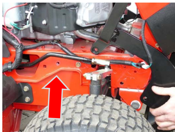
4. Vyšroubujte samořezný šroub po obou stranách traktoru. Podvlékněte rám pod elektrickým vedením.
