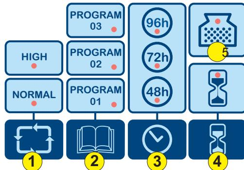
1. Swivel – nastavenie otáčok robota v bazéne.
