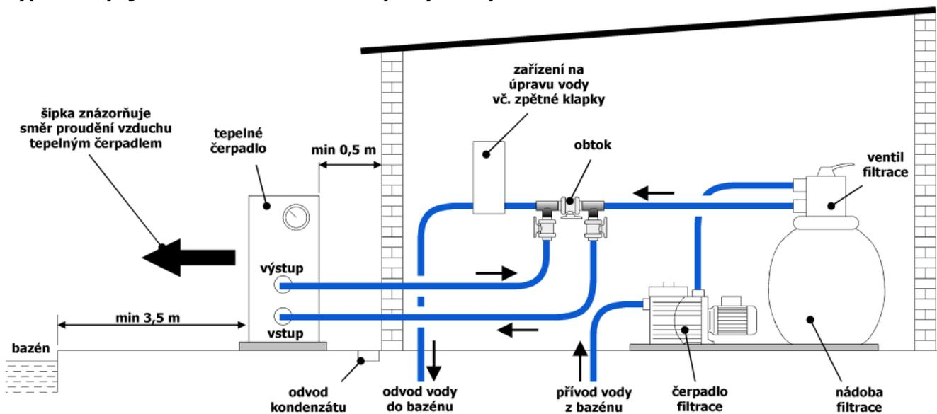
**Poznámka:** Výrobce dodává pouze tepelné čerpadlo. Ostatní součásti na obrázku jsou součástí vodovodního okruhu, které zajišťuje uživatel nebo instalační firma.
