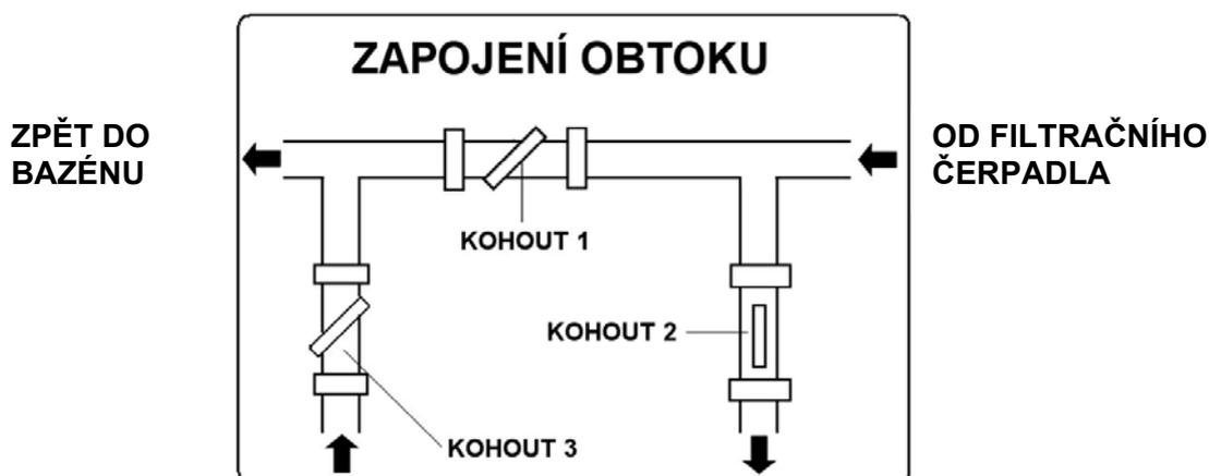
Úplně uzavřete kohout 1 a otevřete kohouty 2 a 3 na přívodu i výstupu z tepelného čerpadla. Za těchto podmínek protéká tepelným čerpadlem maximální množství vody. Uved'te tepelné čerpadlo do chodu v režimu ohřevu. Počkejte, až se hodnota tlaku na tlakoměru ustálí. Správné nastavení tlaku by mělo být v rozmezí od 21 do 35 kg/cm<sup>2</sup> (bar).
